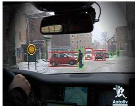
[그림 36] 카메라를 이용한 전방 물체 판독
