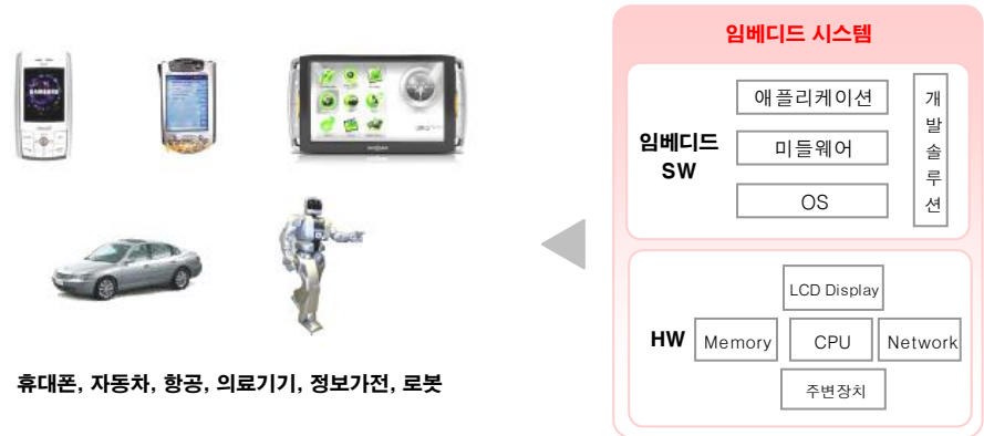
도표 3 임베디드 시스템은 정보가전, 자동차, 휴대폰 등에 내장된 전자제어시스템
